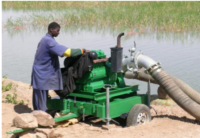
hatz-rovatti pumpaggregat im einsatz am niger
